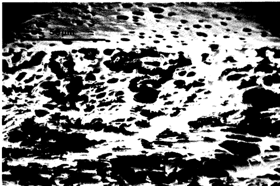
Figure 3.5 : Micrographie à balayage d'une membrane en polysulfone (De Danske Sukkerfabrikker) de porosité 3µm; la surface de la membrane apparaît sur la partie supérieure de la micrographie.
